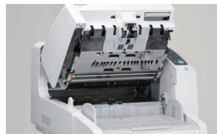
Le boîtier coquille donne accès à tous les éléments de l'appareil.
