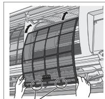
Insérer à l'intérieur de l'appareil
