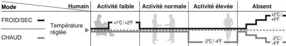
**CONFORT AUTO (AUTO COMFORT)** ; En détectant l'activité et la présence humaines, l'appareil contrôle la température de la pièce pour la maintenir à un niveau confortable.
