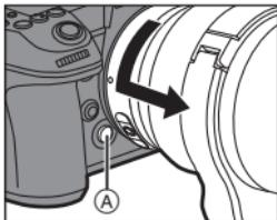
**2 Halten Sie die Objektiv-Entriegelungstaste ② am Telekonverter gedrückt, drehen Sie den Telekonverter bis zum Anschlag in Pfeilrichtung und nehmen Sie ihn dann ab.**
