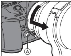
**2** Mientras pulsa el botón de liberación de la lente en el tele convertidor **(B)**, gire el tele convertidor en la dirección de la flecha hasta que se detenga y entonces quitelo.
