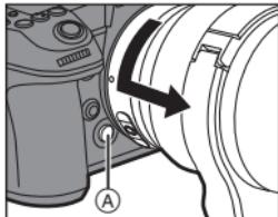
2 按增倍镜②上的镜头释放按钮的同时，朝箭头指示的方向转动增倍镜直到停止为止，然后取下。
