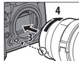
**4** Drehen Sie das Objektiv in Pfeilrichtung, um es an der Digital-Kamera zu befestigen.
