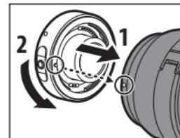
**2** Drehen Sie das Produkt in Pfeilrichtung, um es am Objektiv zu befestigen.
