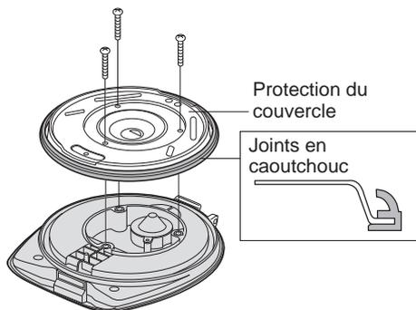
Enlever le couvercle, dévisser les 3 vis taraudeuses et enlever la protection du couvercle. Changer les joints et remettre la protection du couvercle en place en la fixant à l'aide des vis taraudeuses.
