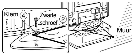
\* Gebruik een stevige in de handel verkrijgbare kabel of ketting om de plasmatelevisie aan een solide gedeelte van een muur of pilaar te bevestigen.
